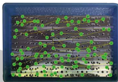
目視検査：視線遷移解析 (穴開け位置や傷検査)
