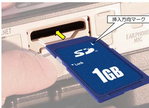
③ SD カードの端子面を下にし、カードの挿入方向マーク(△)の指す方向に向かってスロットに差込んでください。
