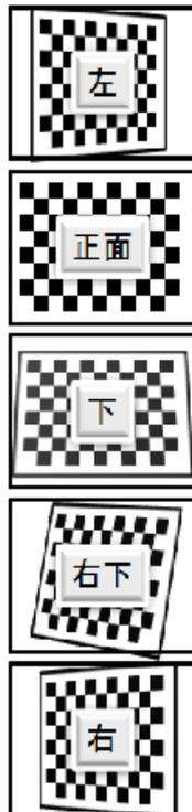
② 刺激ベース画像カメラでチェスボードをデジタルカメラで撮影します。
